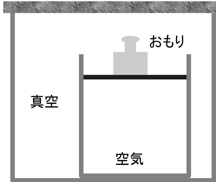
図 2.4: 圧力の測定(容器内の気圧)
