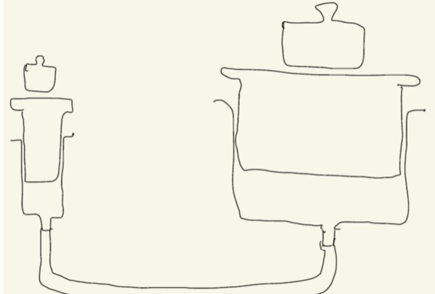
図 2.2: 圧力についての 2 つのシリンジの実験
