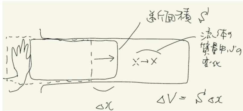
図 3.2: ピストンを押す力がする仕事
