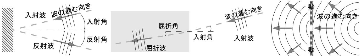
図 5.9: 波の性質の模式図 (左: 反射 中: 屈折 右: 回折)
