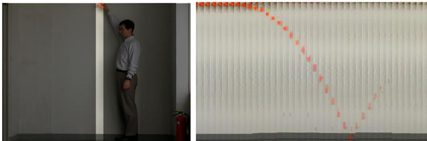
図 3.9: ボールが落下する様子を移したビデオの一場面。右手にボールを持っている(左)。各画像からボールの部分短冊状に切り出した画像を並べたもの(右)
