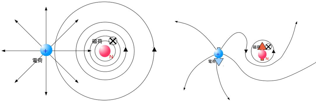
図 4.6: 電気力線による説明 (左) 電荷と走る磁荷の作る電場を単独で表したもの (右) 重ね合わせた電場の電気力線
