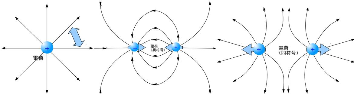
図 4.5: 電気力線による説明 (左) 点電荷の周りの電場 (中) 互いに引き合う電荷 (右) 反発し合う電荷
