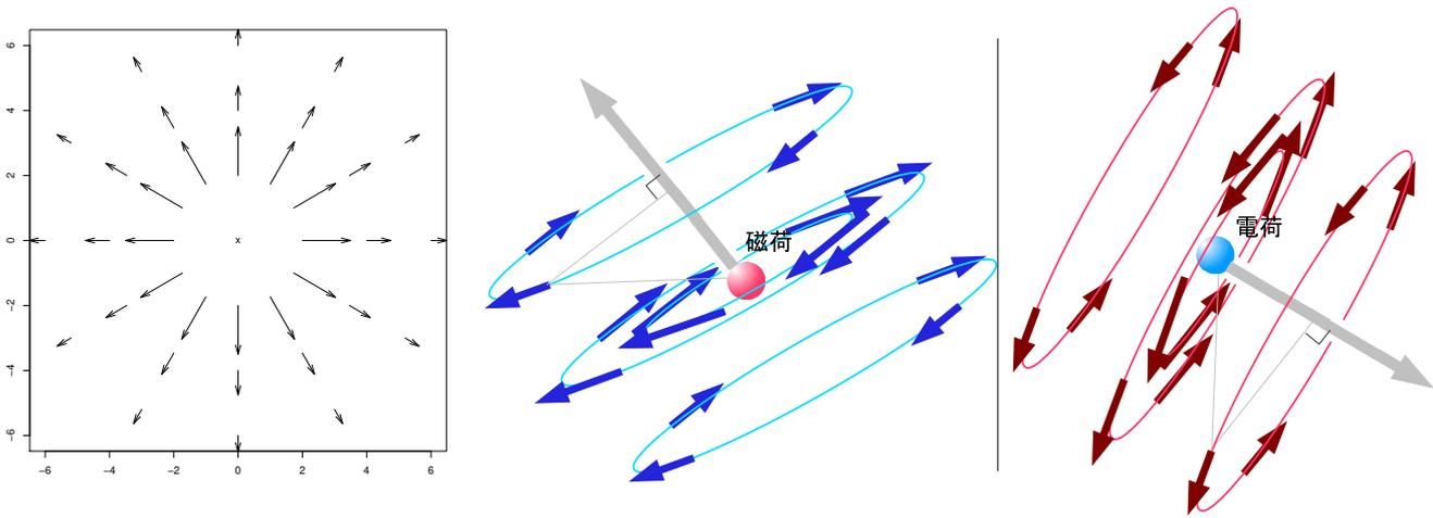
図 4.2: ベクトル場の模式図 (左: 点電荷の周りの電場 中: 走る磁荷の周りの電場 右: 走る電荷の周りの磁場)
