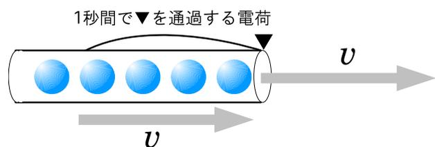
図 4.9: 運動する電荷と電流
