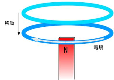
図 4.11: 磁石の近くでコイルを動かすことで発生する電場
