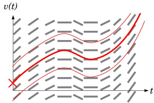
図 3.18: 各点での傾きから  $v(t)$  を決める
