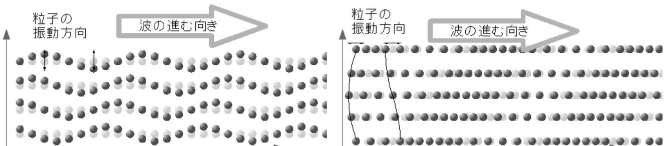
図 5.8: 左:横波の模式図 右:縦波の模式図
