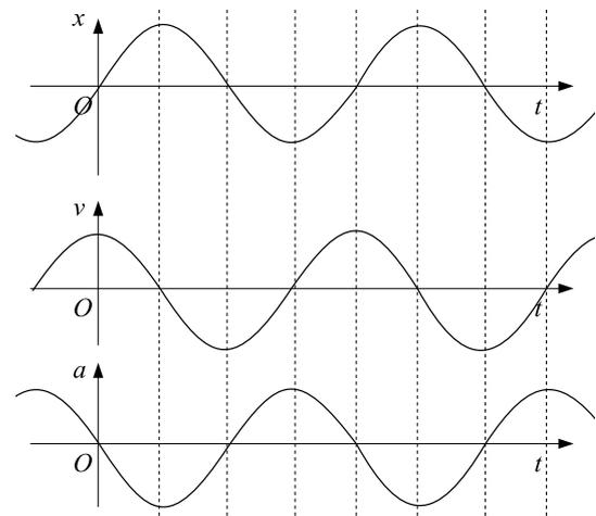
図 5.2: 単振動の変位(上), 速度(中), 加速度(下)
