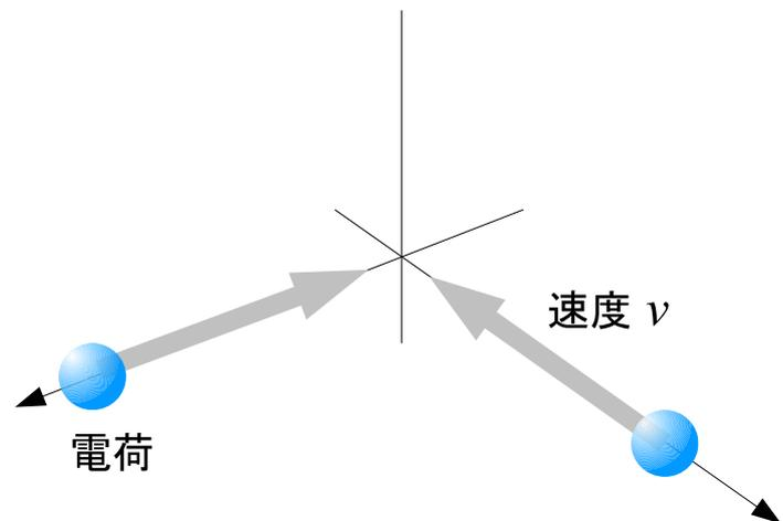
図 6.1: 直交する方向から接近する電荷
