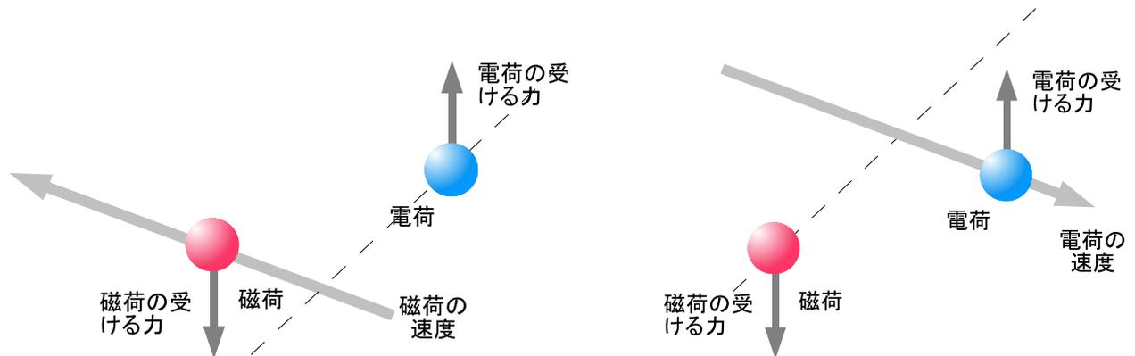
図 4.1: 磁荷と電荷との間で作用する力 (左: 磁荷が走る場合、右: 電荷が走る場合)
