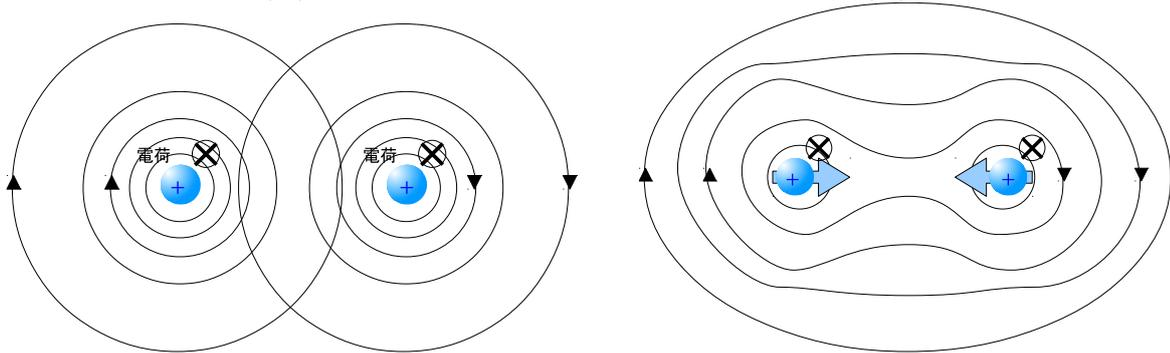
図 4.7: 電気力線による説明 (左) 並走する電荷が作る磁場を単独で表したもの (右) 重ね合わせた場磁場の磁力線
