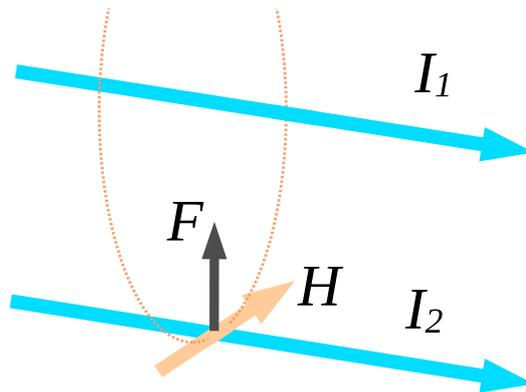
図 4.12: 平行して流れる電流に作用する力
