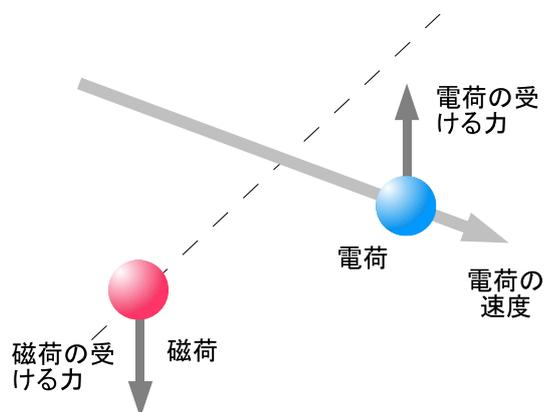
図 6.2: 磁荷と電荷との間で作用する力(電荷が走る場合)
