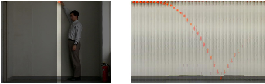
図 10: ボールが落下する様子に移したビデオの一場面(左)と、各画像からボールの部分短冊状に切り出した画像を並べたもの(右)
